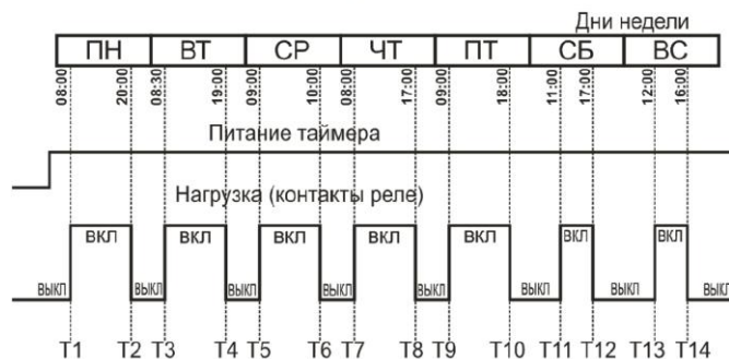
Рисунок 3.4 – Включение нагрузки на примере недельного режима работы
